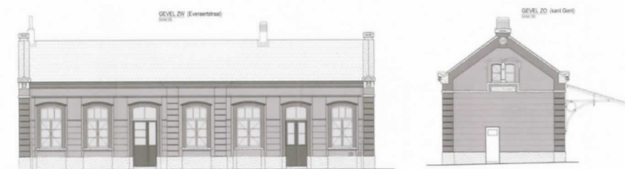
iii. 84 Reconstructieplan van de voor- en rechterzijgevel van het stationsgebouw van Oostkamp. Het oude haltebord, de originele schoorstenen, de ijzeren topstukken en de originele indeling werden gereconstrueerd volgens origineel model.
